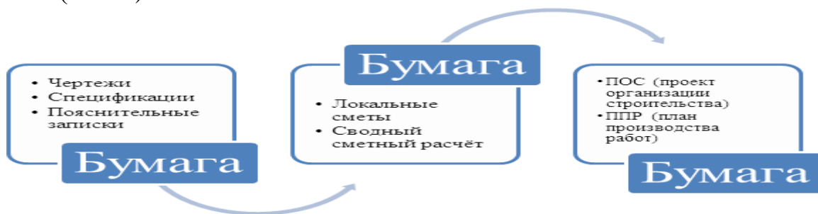
Рис. 2. «Линейный» тип проектирования с бумажным способом обмена
