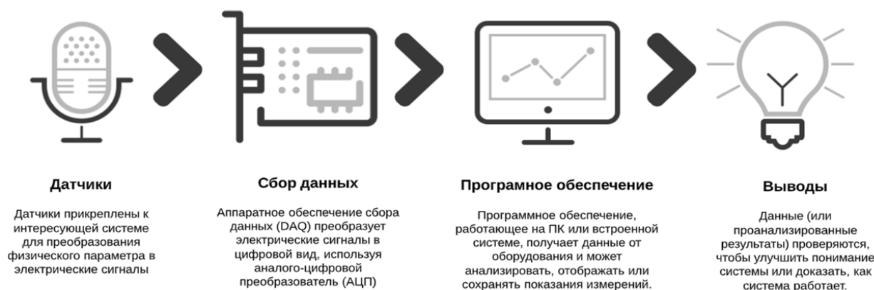
Рисунок 1. Процесс сбора данных в измерительных системах
