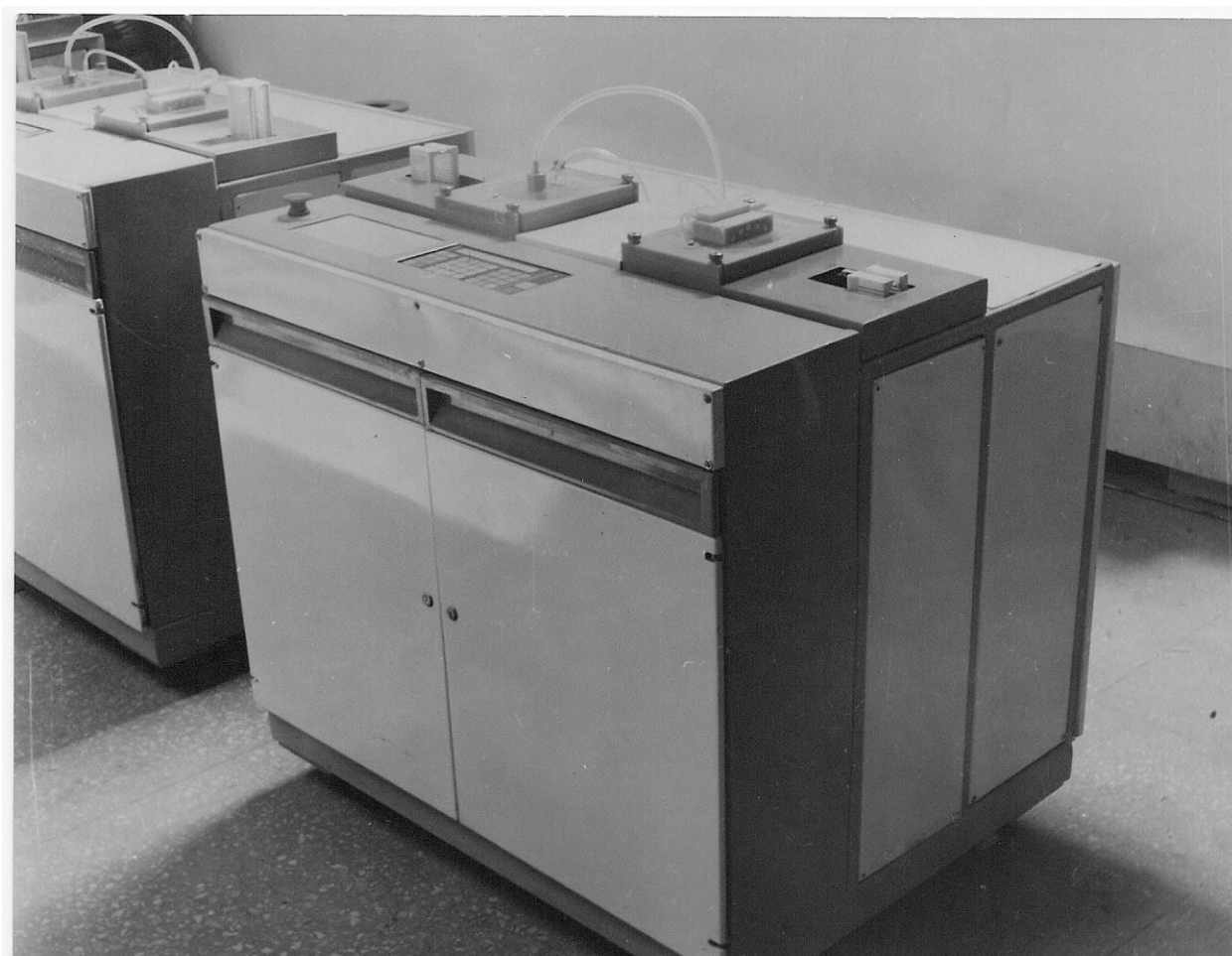
Рисунок 9. Поточная автоматическая производственная линия для полного цикла фотолитографии и техно-химии на платах тонкоплёночных микросборок с гибкой организацией локального технологического процесса в рамках каждой, входящей в линию установки, - по классификации ТРИЗ, - линия – техническая система высшего уровня иерархии – надсистема, каждая установка в составе линии – техническая система среднего уровня иерархии -надсистема, каждая рабочая позиция – техническая система низшего уровня иерархии – подсистема
