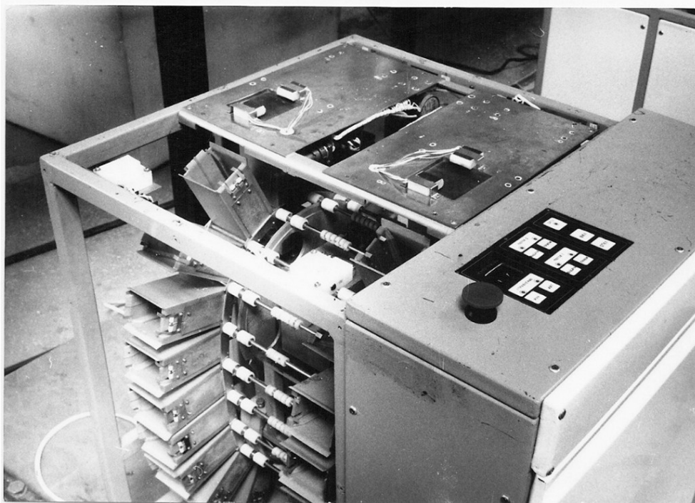
Рисунок 11. Внутренняя структура модуля накопителя. Как видно из рисунков, модуль накопитель имеет вертикальный конвейер, в котором закреплены ячейки куда устанавливаются или откуда вынимаются кассеты с заготовками
